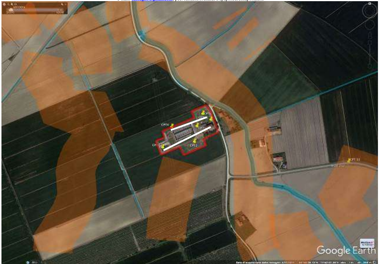
Fig. 1/3: Area in esame, ubicazione dei punti di indagini relativi all'oggetto della presente relazione. Scala libera, su orto- foto aerea tratta da Google Earth ®. Si sono riportate le paleo forme divagative di cui si dirà in relazione e le tracce delle sezioni stratigrafiche locali che saranno illustrate più oltre in relazione.
