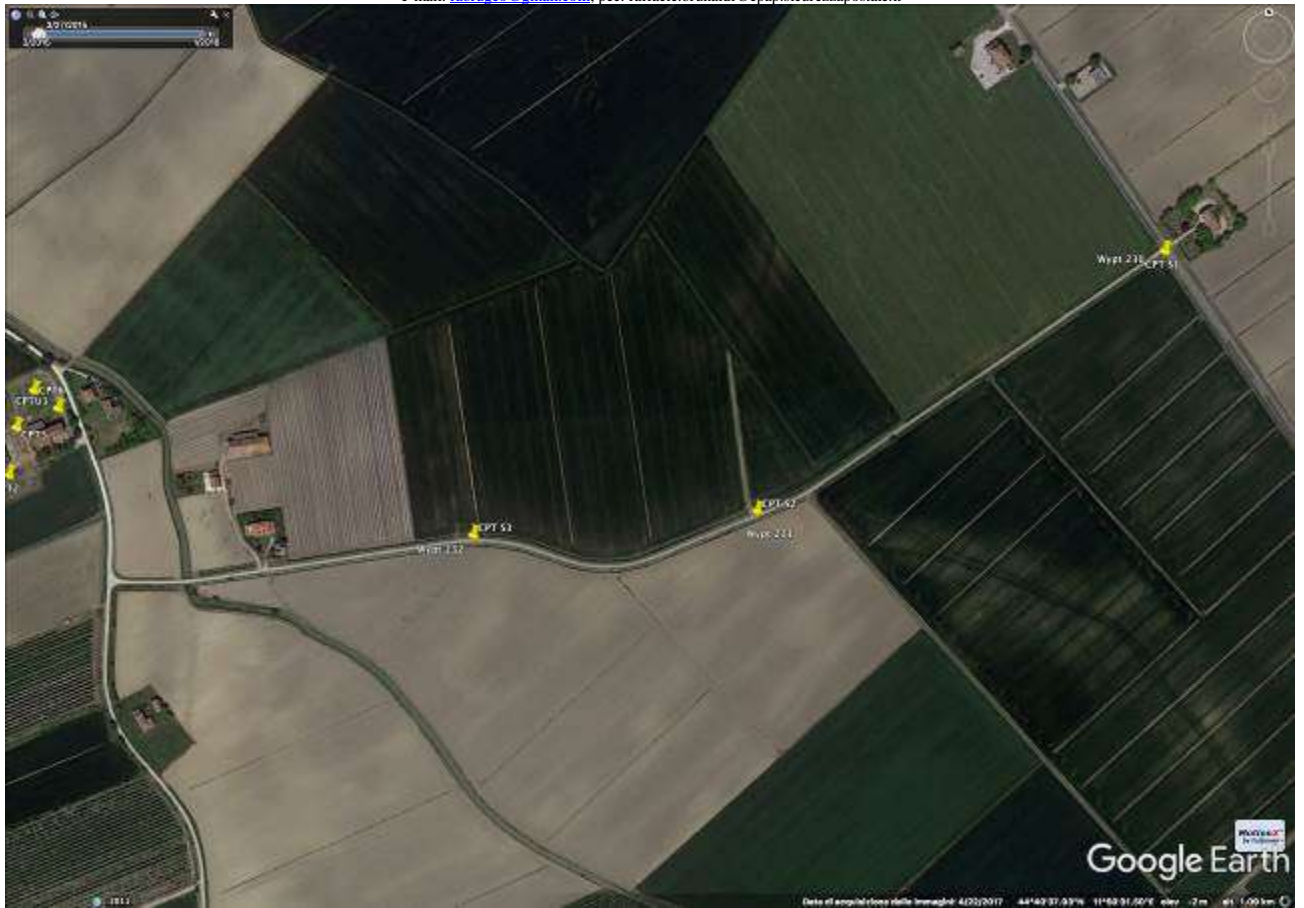
Fig. 14/1: Ubicazione a Scala Libera su orto- foto tratta da Google Earth (C) dei punti di ubicazione delle C.P.T. 1, 2 e 3 (da Est ad Ovest). Si osservi come buona parte di Via Bonacciola ricalchi un evidente paleo corpo divagativo.
