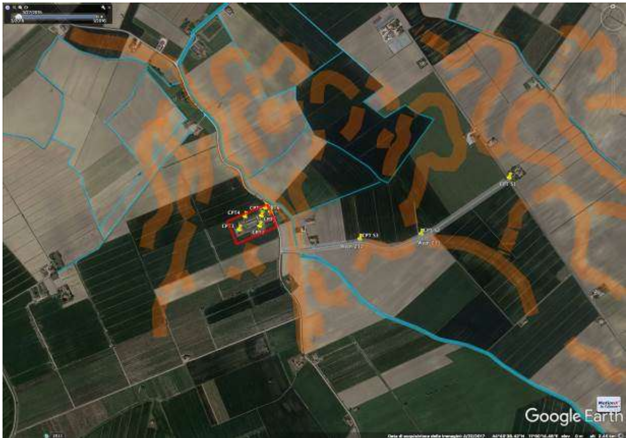
Figg. 1/2: Area in esame, ubicazione dei punti di indagini relativi all'oggetto della presente relazione. Scale libere e diverse la prima dalla seconda, su orto- foto aeree tratte da Google Earth ®. Si sono riportate le paleo forme divagative di cui si dirà in relazione e le tracce delle sezioni stratigrafiche locali che saranno illustrate più oltre in relazione.
