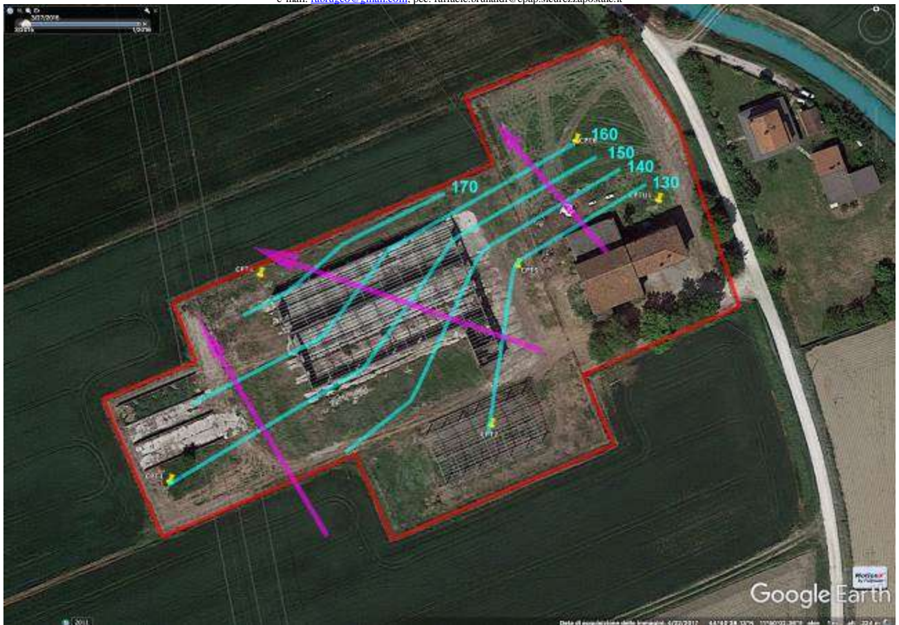
Fig. 6/2: Carta a Scala Libere delle Isobate: sono riportate le profondità della falda in m s.l.m.m. e sono riportate le direzioni di drenaggio/deflusso sotterraneo della falda. redatta dallo scrivente su orto- foto tratta da Google Earth (C).
